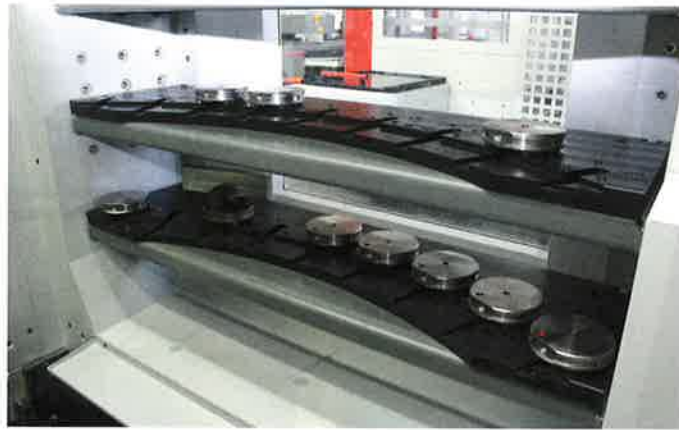
Bild 3. Handlingsystem HS flex mit Speichermodul 1+2: Zahlreiche Optionen erlauben die individuelle Anpassung an die Kundenwünsche. Bild (3): Hermle
