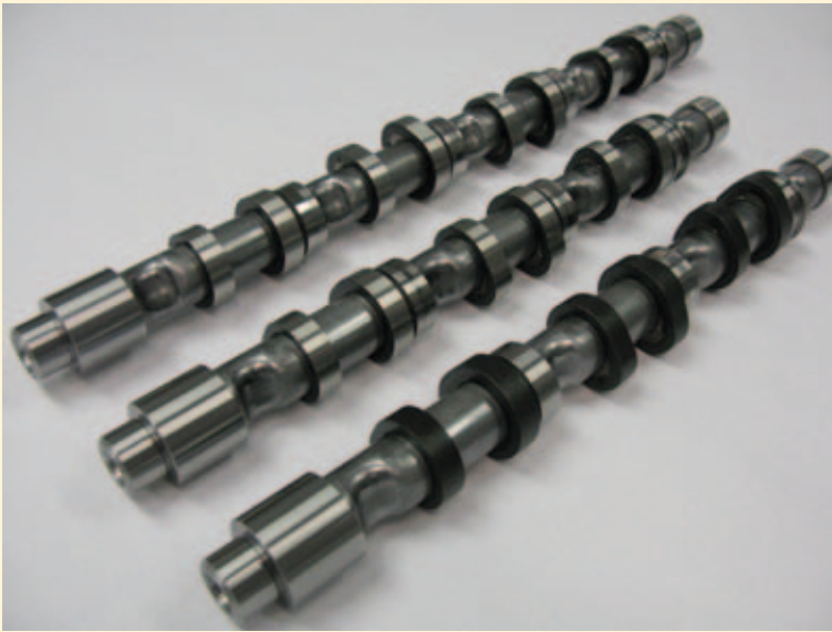
Abb. 3 Dreizylinderwelle roh, Dreizylinderwelle geschliffen und Vierzylinderwelle geschliffen. Quelle: Volkswagen AG
