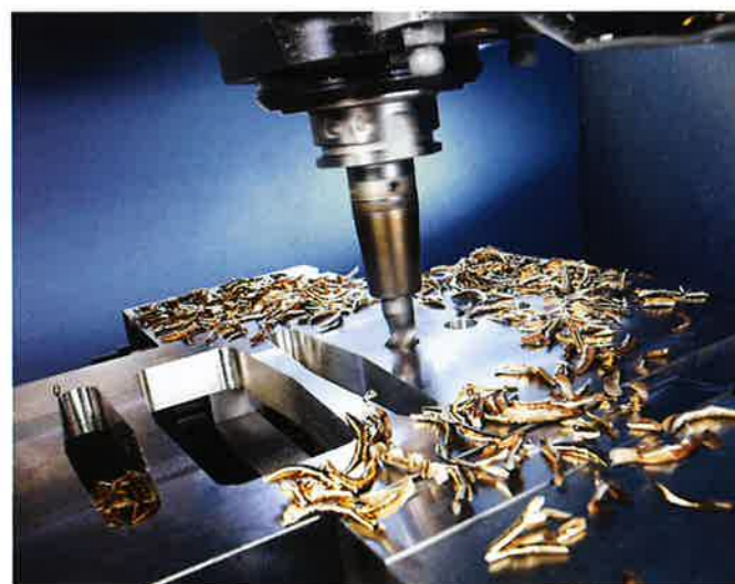
Bild 1: Bei der Bearbeitung mit Minimalmengenschmierung (MMS) sind die anfallenden Späne nahezu rückstandsfrei und können direkt der Wiederverwendung zugeführt werden (Werkbild: bielomatik Leuze)
