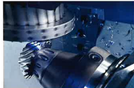
Bild 1: In der Zahnradfertigung ist der prognostizierte Siegeszug der Trockenbearbeitung eingetreten. Die Schnittgeschwindigkeiten sind bis zu 5-mal so hoch wie in der Nassbearbeitung vor 20 Jahren (Werkbild: Klingelberg)
