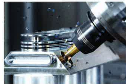
Bild 2: Die Minimalmengenschmierung bietet einige Vorteile: hohe Kosten für die Pflege, Aufbereitung sowie Entsorgung üblicher Kühlschmierstoffe (KSS) entfallen und Energiekosten sinken (Werkbild: Horn – Saueremann)
